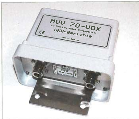
Bild 7: MVV 70; Vorverstärker für 70 MHz
