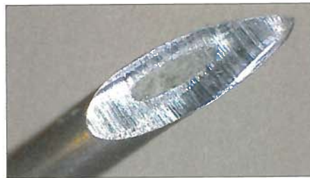
Bild 6: Schnitt durch einen 0,8 mm dicken Elektronik-Lötendraht Fotos: DL1SNG
