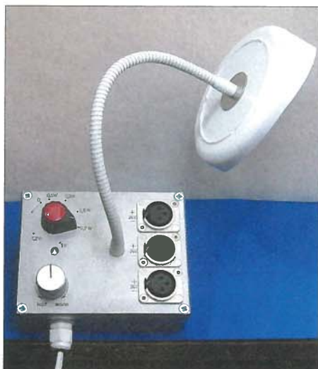
Bild 1: LED-Lampe im Aluminiumgehäuse mit dem schräg abgeschnittenen Unterteil einer Kunststoffdose als Blendschutz; die drei optionalen XLR-Buchsen sind für weitere 24-V-Geräte vorgesehen. Fotos: Franke
