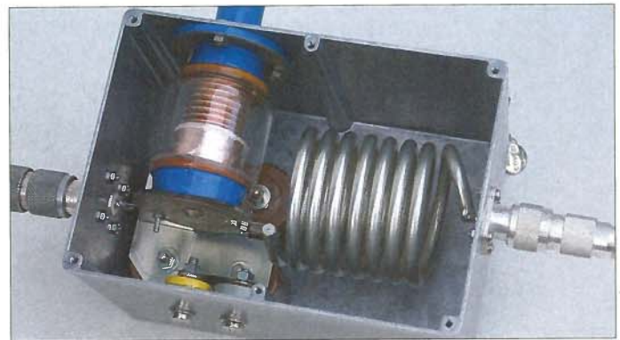
Bild 12: Anpassnetzwerk für den Betrieb auf dem 80-m-Band; zu erkennen sind die Spule aus 7,8-mm-Semi-Rigid-Kabel, Vakuumdrehkondensator und Glimmerkondensatoren
