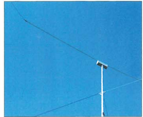
Bild 3: Detailansicht des Dipoleinspeisegehäuses nebst Abspannungen; links ist der vom 2 m langen Aluminiumrohr im Winkel abgehende Draht zu erkennen.
