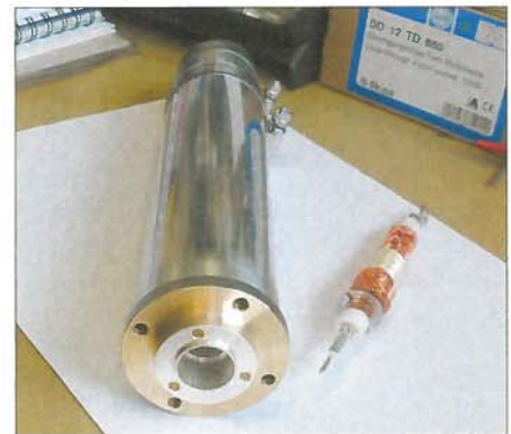
Bild 5: Mechanischer Passungstest des Kurzschlussstücks am unteren Mastende
