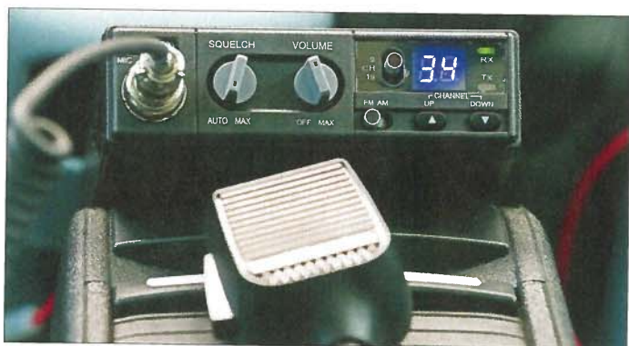
Das CB-Mobilgerät CRT S Mini funkt in AM sowie FM und lässt sich schnell im Kfz installieren.
