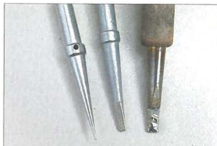
Bild 3: Auswechselbare Lötspitzen von 0,4 mm bis 2,4 mm
