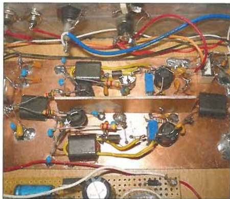
Bild 1: Ausführungsbeispiel für einen Doppel-Norton-Verstärker in freier Verdrahtung Foto: DK6ED
