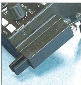
Die Pico Plate gestattet die Befestigung des Pico Paddle an jedem Transceiver.
