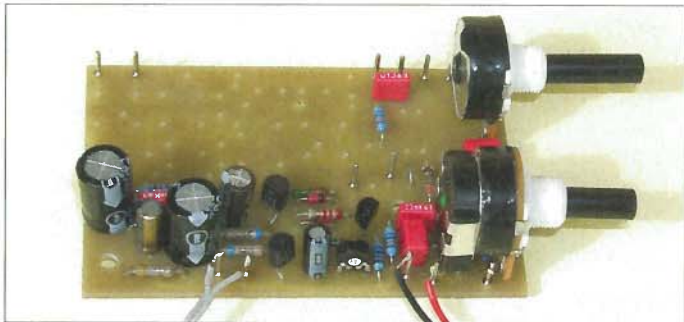
Bild 10: Bestückte NF-ZF-Platine mit allen in dieser Ausbaustufe benötigten Bauteilen
