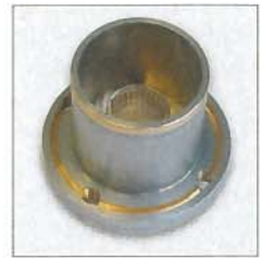
Bild 4: Kurzschlussstück für die Verbindung Koaxialkabel-Außenleiter/unteres Mastende; ein versilberter Kupfer-Beryllium-Federkranz stellt den Kontakt her.
