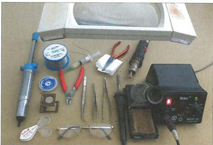
Bild 1: Werkzeuge fürs Handlöten unter einer Lupeleuchte mit zwei Kompaktleuchtstofflampen; vorn rechts steht das Heißluft-Entlötlötgerät (diverse Düsen nicht im Bild).
