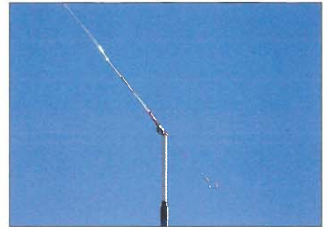
Bild 9: Westseite des Dipolendes mit einem Abstimmstab aus 1 mm Federstahl nebst einem kleinen Koronaring
