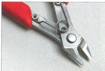
Bild 4: Hochwertiger sogenannter Elektronik-Seitenschneider , speziell zum Bearbeiten bedrahteter Bauelemente
