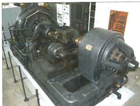
Bild 5: Maschinensatz mit Motor, Getriebe und Alternator (v. r. n. l.)
