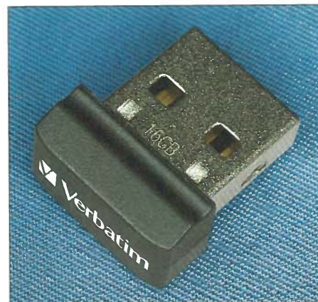
Bild 6: Ein wegen minimaler Bautiefe besonders geeigneter USB-Stick
